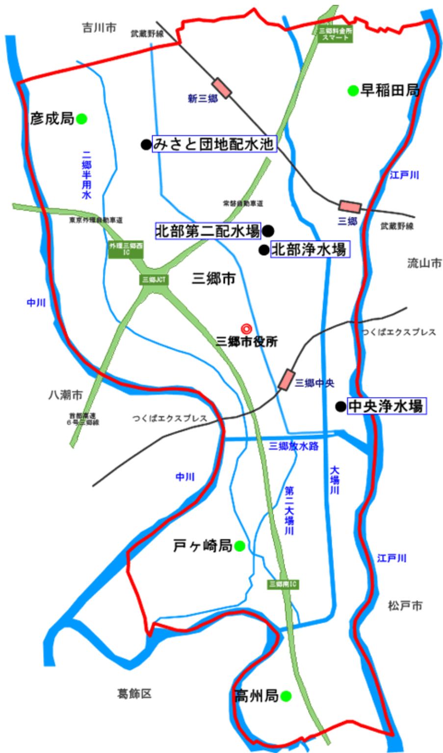
図1 浄配水場の給水区域と施設図
