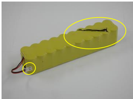
(チューブケース破損 ／コネクター部露出)
