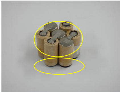
(電池端子連結部露出)
