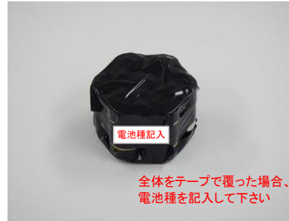
(電池端子連結部の被覆 ／電池の固定)
