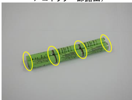
(電池端子・端子連結部露出)
