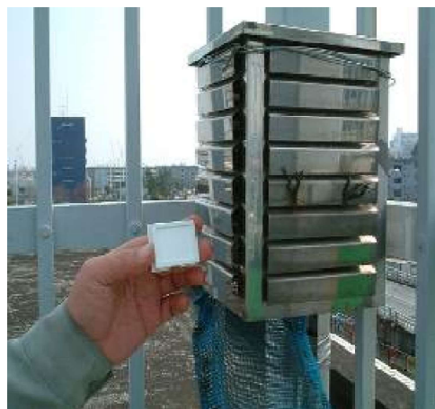
写真：フィルターバッチ設置風景
