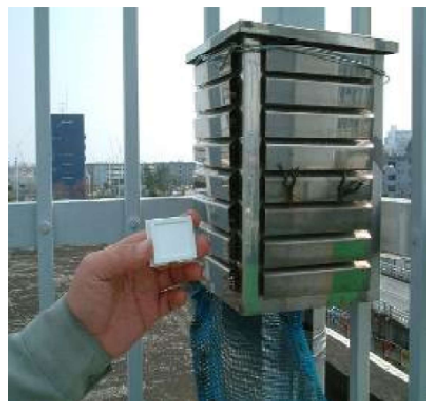
写真：フィルターバッチ設置風景
