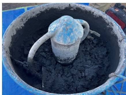
図 6 モルタルミキサー混合状況 (No. S3)
