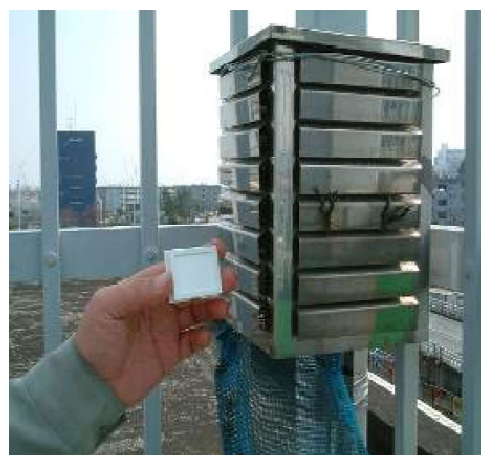
写真：フィルターバッチ設置風景
