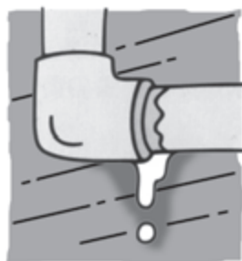
壁の中の漏水
