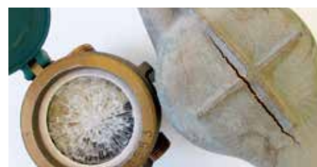
〈凍結により破損した水道メーター〉
