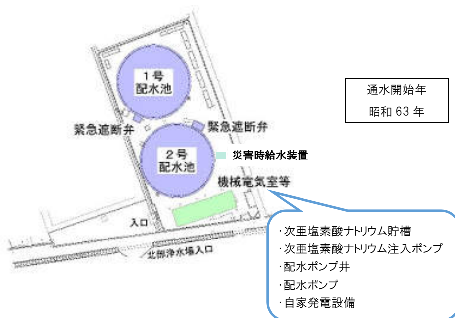
図 2-10. 北部第二配水場の配置図
