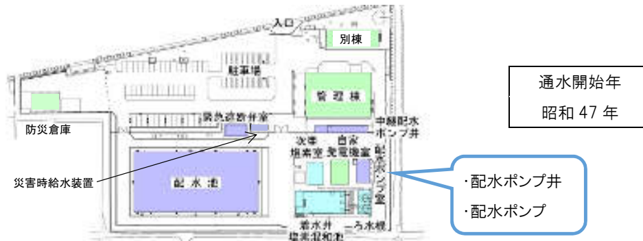
図 2-9. 北部浄水場の配置図
