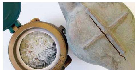
〈凍結により破損した水道メーター〉
