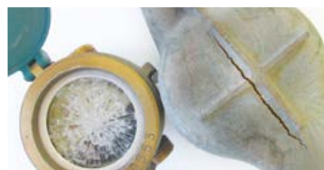
〈凍結により破損した水道メーター〉
