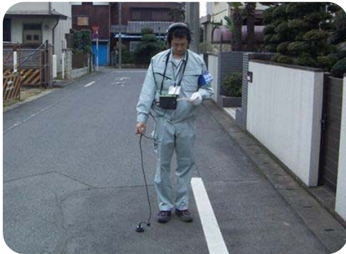
図 5-11.漏水調査（路面音聴）
