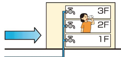
直結給水式には直結増圧式と3階直結直圧式の2種類があります。
