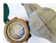
(凍結により破損した水道メーター)
