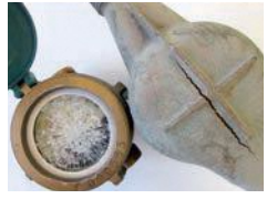
（凍結により破損した水道メーター）
