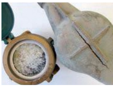
〈凍結により破損した水道メーター〉
