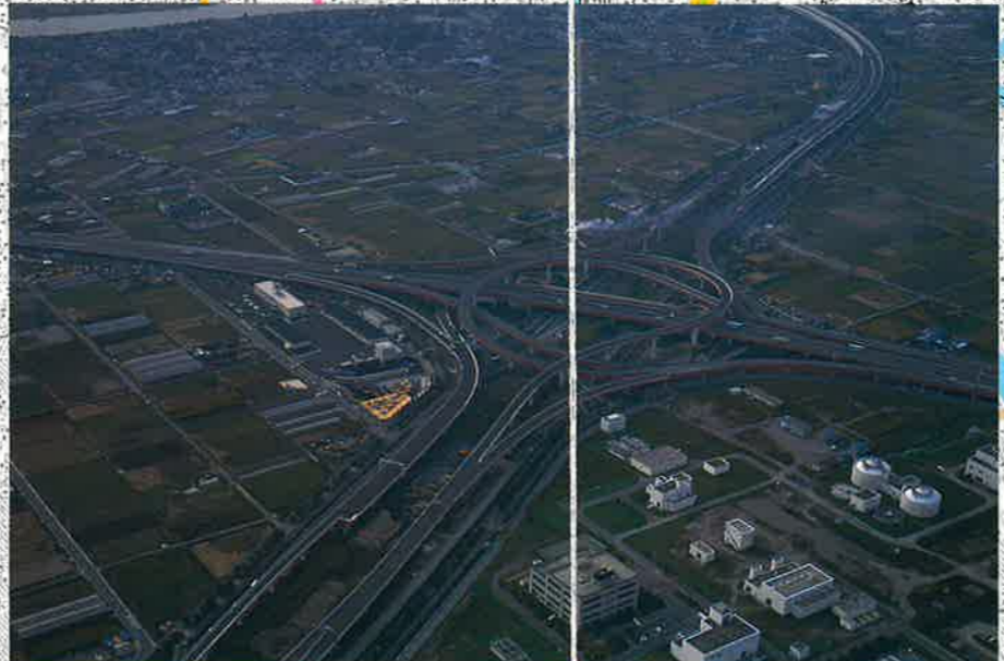
三郷インターチェンジは、外かんの自動車専用部、常磐自動車道、首都高速道路足立・三郷線および一般国道298号が接続するタービン型（高架式）3層構造のインターチェンジで、その広さは27万平方メートルで全国でも有数のインターチェンジです。
