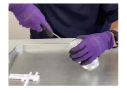
錐で穴を大きくします。燃焼 孔はある程度の大きさがある と本燃焼しやすくなります。 Enlarge the hole with a drill bit. If the combustion hole is of a certain size, it will be easier to carry out actual combustion.
