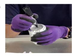
コンパスの針を置くため の中心を定めます。 Determine the center for placing the compass needle.
