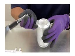
間隔が均等になるように油性ペンで印を付けます。8か所くらいが目安です。 明確な決まりはありません。 Mark with a permanent marker to ensure equal spacing. A guideline is about 8 locations. There are no clear rules. 2)
