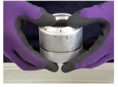
上部が底部の上になるように 重ねます。燃料の注ぎ口や缶 の切断部分でケガをしない様 に気を付けましょう。
