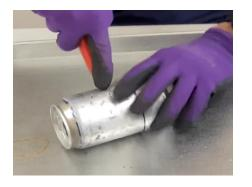
底部から作ります。 燃焼孔を開けた方の缶を先に切断します。3.5cmより上の部分は使用しないため大体の位置で切断し、後から整えましょう。 Start from the bottom. Cut the can with the combustion hole drilled first. The part above 3.5cm will not be used, so cut it at the approximate position and trim it later.
