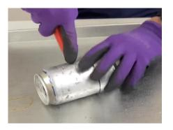
燃焼孔を開けた方の缶を先に切断します。3.5cmより上の部分は使用しないため大体の位置で切断し、後から整えましょう。 Cut the can with the combustion hole drilled first. The part above 3.5cm will not be used, so cut it at
