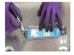
切れ端をテープで固定して油性ペンで印をつけます。 Secure the cut ends with tape. Mark with a permanent marker.
