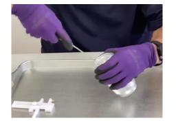
きりで穴を大きくします。燃 焼孔はある程度の大きさがあ ると本燃焼しやすくなります。 Enlarge the hole with a drill bit. If the combustion hole is a certain size, it will be easier to carry out actual combustion.
