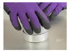
そのままだと入らないので、下部を上から1cmほどを目安にラジオペンチで絞っていきます。 It won't fit in as is, so use needle-nose pliers to squeeze the bottom part about 1cm from the top.
