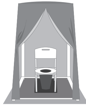
マンホールトイレ
