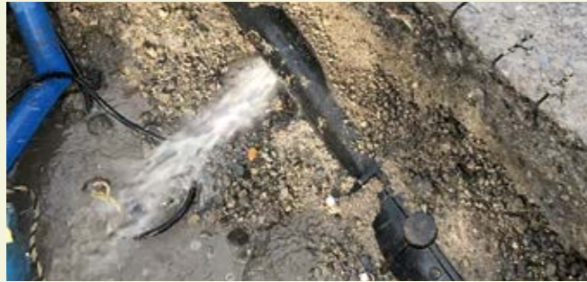
老朽化した水道管から水が漏れる様子
